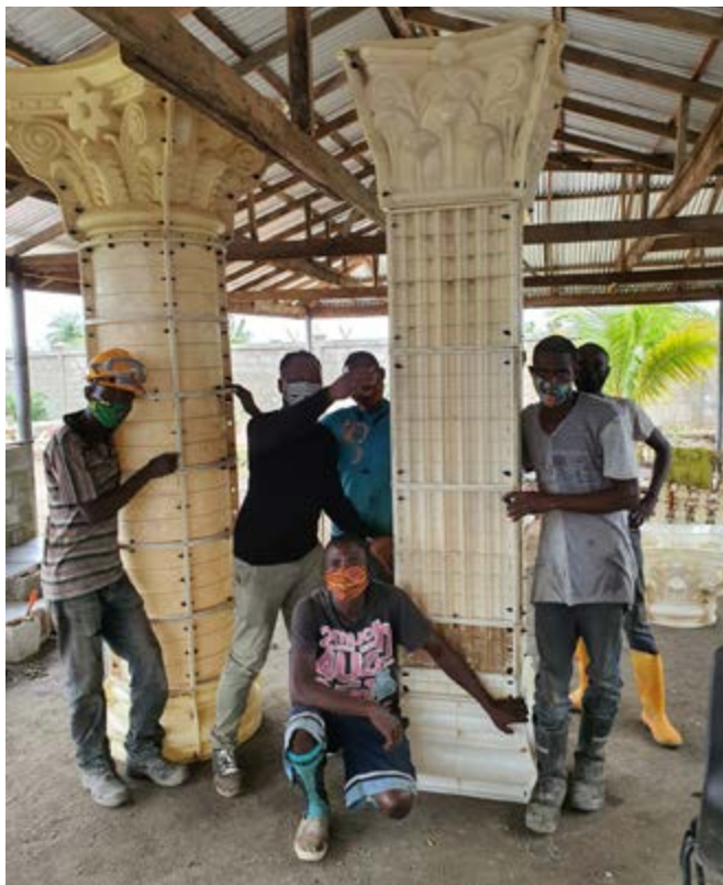
Blij met nieuwe mallen voor pilaren
